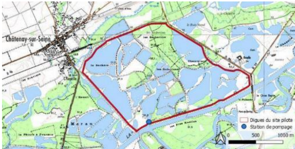
Tracé de l'espace endigué sélectionné à l'issue des études préliminaires et position de la station de pompage et de l'ouvrage de vidange intégré / Source : EPTB Seine Grands Lacs
